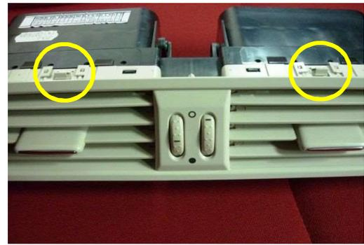
吹出口上部に2ヶ所ツメがありますが、かなり硬いので吹出口を下に押し下げのような感じで取外して下さい。
