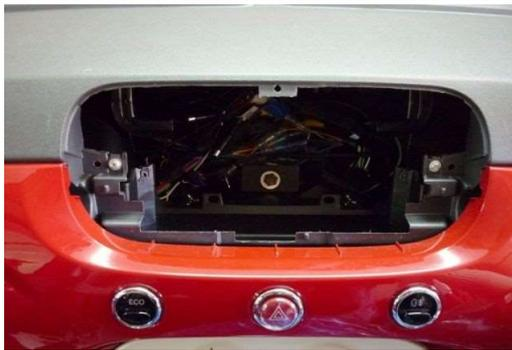
ビス2本を外して、エアコン吹出口を取外して下さい。
