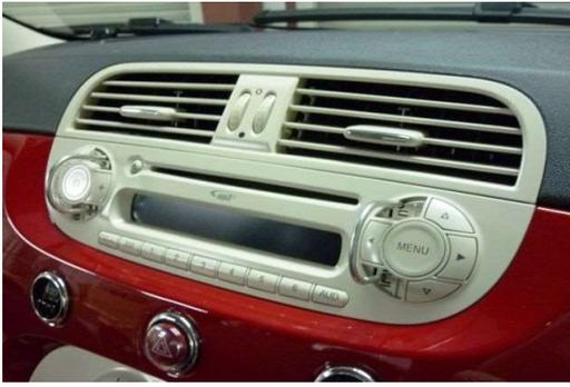
純正デッキ取外し工具を差し込み、純正デッキを取外して下さい。
